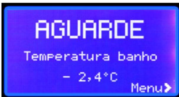
A temperatura normal de trabalho é de -7C., mas quando atingir - 4C, o crioscópio já poderá ser utilizado e haverá uma mudança de tela, conforme abaixo:
